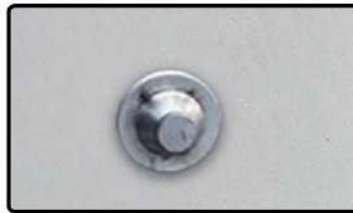
Push gun into the steel/wall quickly ٤. ادفع المسامير في الفولاذ/الجدار بسرعة
