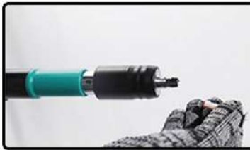
Put the nail into the gun hole ١. أدخل المسامير في فوهة مسدس الطلق
